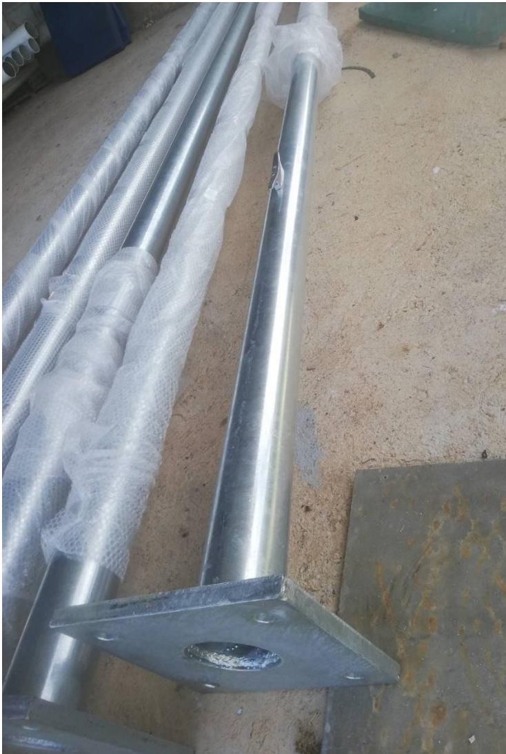
ตัวอย่างเสาธงเหล็กขบกล้าไนซ์ 4 มม. ฐานสี่เหลี่ยมขนาด 450 มม. หนา 25 มม.
